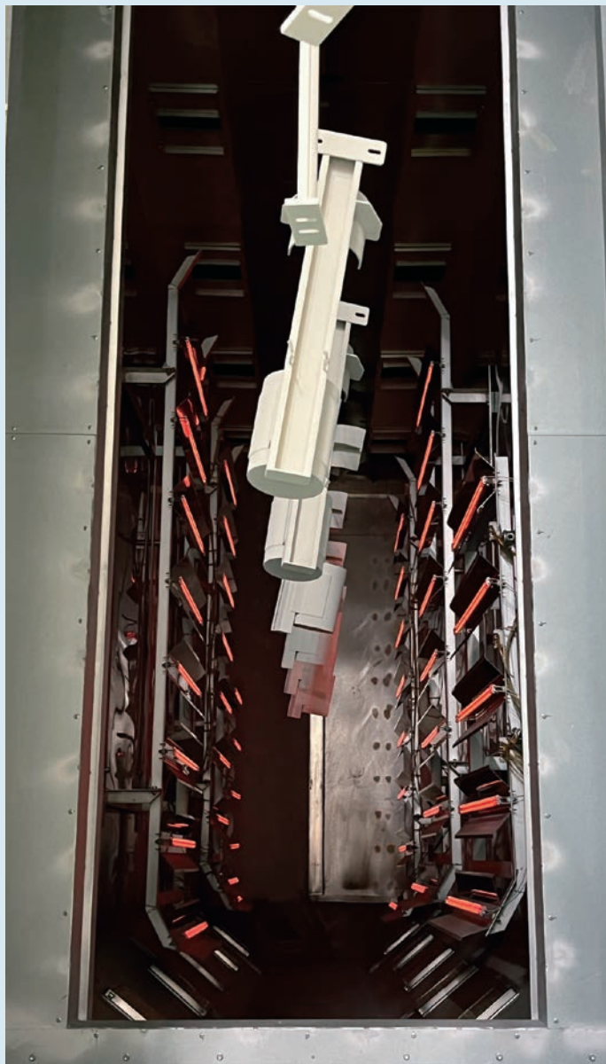
▲ハイブリッド乾燥炉入口側(中波長赤外線ヒーターを採用)
